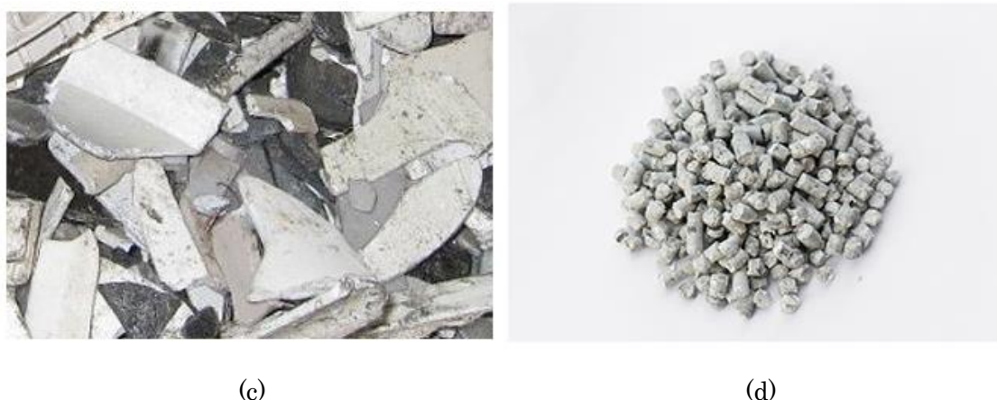
図 3-2 粉碎・選別された各金属：(a)鉄 (b)銅 (c)プラスチック (d)ウレタン
