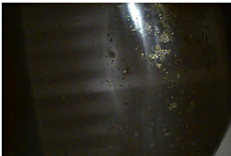
図 2-3 電子機器粉碎物の磁気アルキメデス浮上[9]
