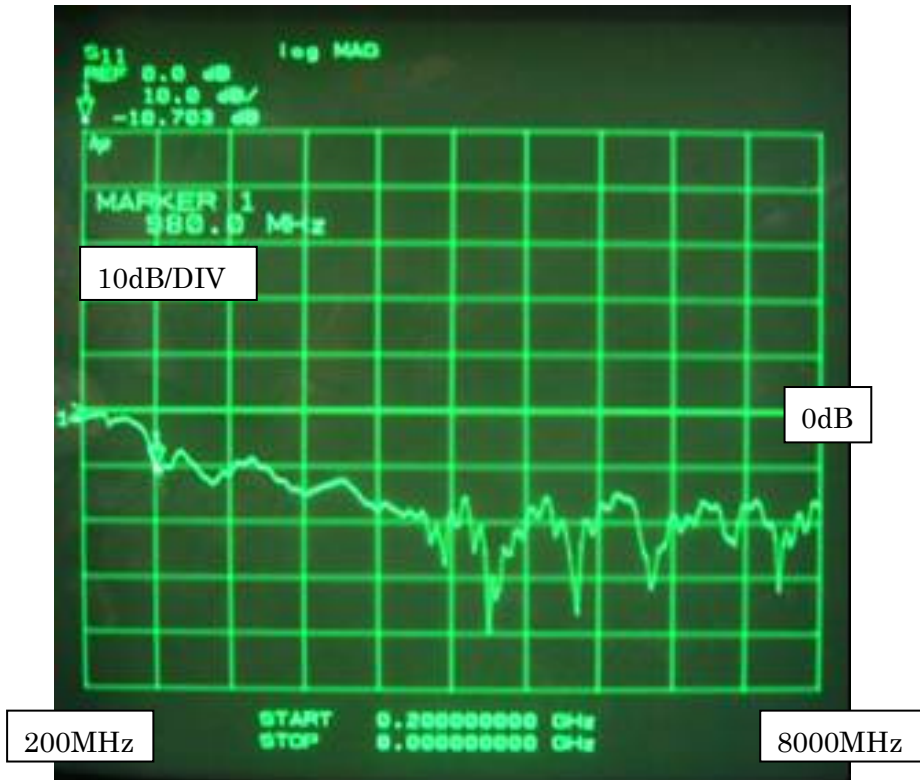
図 2. 37 使用したスパイラルアンテナのリターンロス (0.2~8.0GHz)
