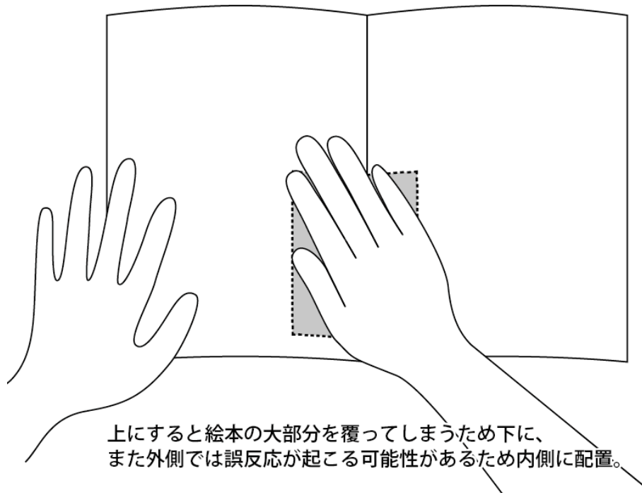
図12 「覆う」仕掛け作動時の手とパターンの位置関係
