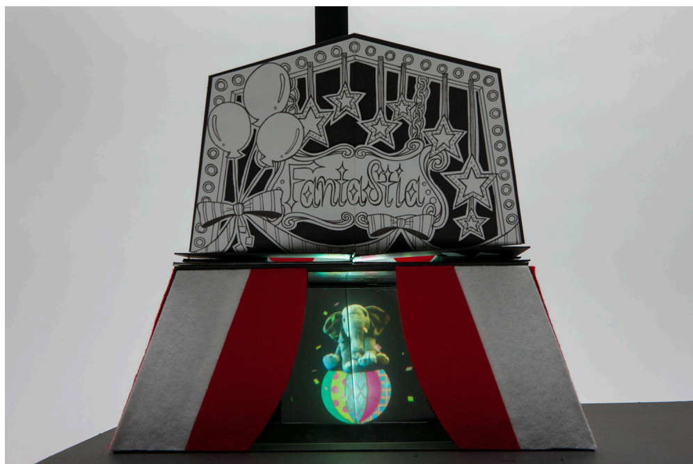
図1 プロジェクタを用いた立体視仕掛け絵本
