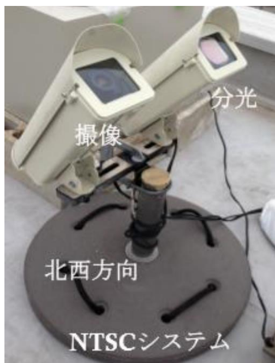
図 3 流星観測に使われているカメラと分光器 3)
