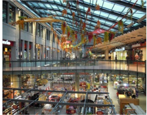
内観② 中央に設けられたアトリウムの様子。旧棟と新築棟を連結している部分が売り場になっている。上部にかけられたブリッジが空間にメリハリをもたらしている。屋根はガラス張りで新設された。
