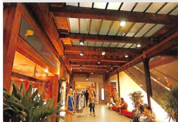
内観(3) 古材の梁に対して補強の金物を使用されている。 ストリートファニチャーのように家具が置かれている。
