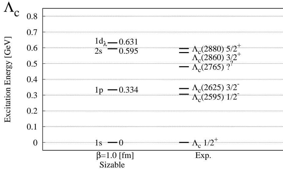
図 2.5: Sizable model による  $\Lambda_c$  の励起スペクトルの計算値と実験値の比較。1p 軌道の実験値を再現するには、ダイクォークの広がりパラメータが  $\beta = 1.0[\text{fm}]$  であることがわかった。実験値は [6] より引用。
