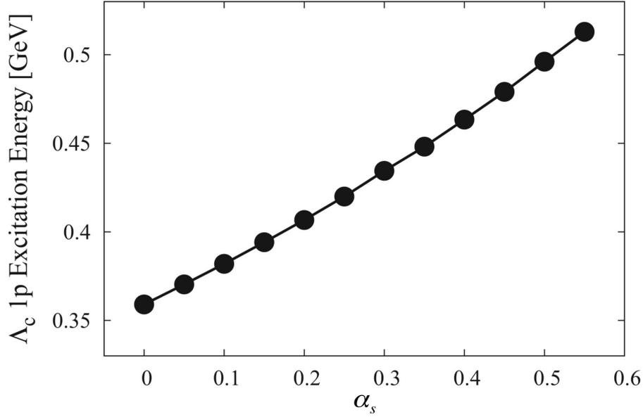
図 2.4: 励起スペクトルの  $\alpha_s$  依存性。  $\alpha_s$  を変えたとき、  $k = 0.9[\text{GeV}/\text{fm}]$  での計算値では  $\Lambda_c$  の 1p 軌道の実験値を再現できないことを確認した。 [5] より引用。
