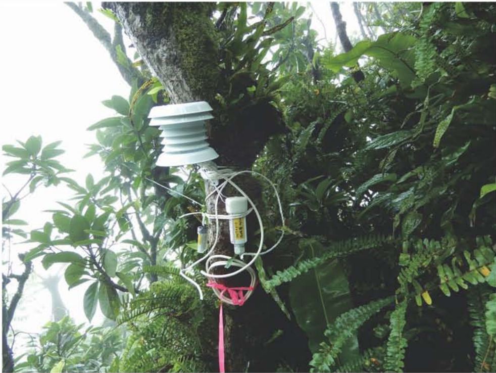
図2. 736m に設置した温湿度データロガー
