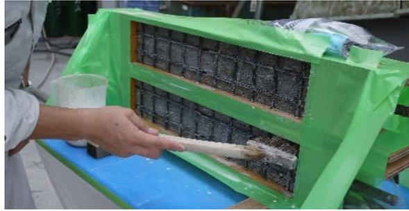
Figure 3-5: Applying epoxy primer
