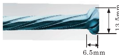
写真-2.4.3 細径异形 PC 鋼棒 (U7.1) 先端の形状
