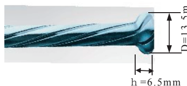
写真-5.3.1 細径異形 PC 鋼棒 (U7.1) 先端の形状
