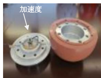
ヘッドフォームインパクトの 重心位置に加速度計を設置した
