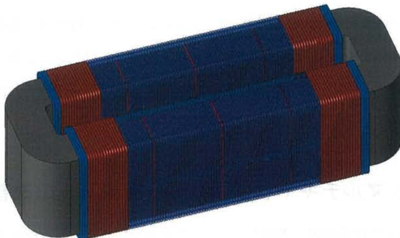
図4.50 マルチギャップダミー巻線モデル修正版(斜めから)
