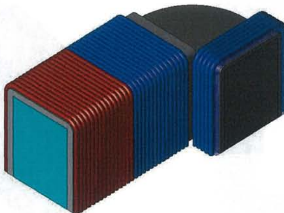
図5.7 インダクタ4の1/8シミュレーションモデル(抑制パート込み)
