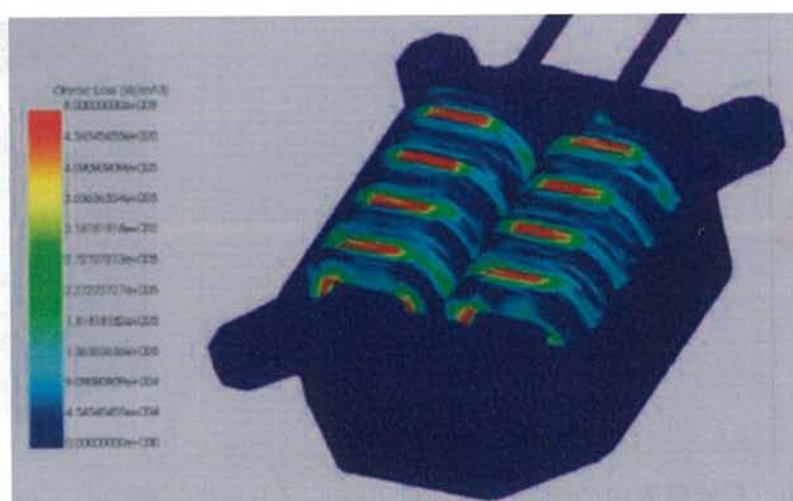
図2.9 電磁界解析による熱計算(参考文献[8]より引用)
