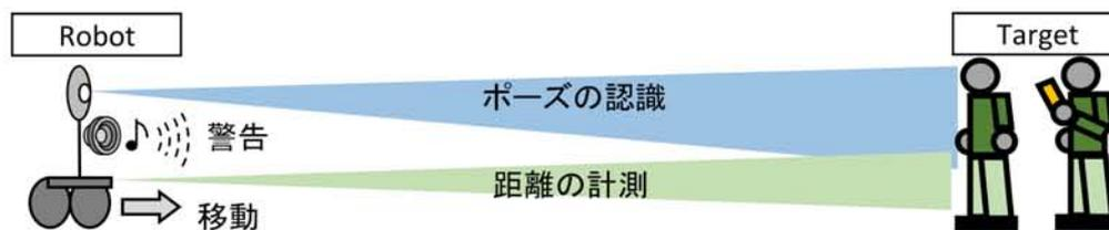
Fig. 43 Robot が注意力のある Target と注意力のない Target に接近する環境。
