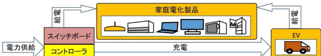
Fig. 10 家庭内の需要電力平準化のためのシステム構成.
