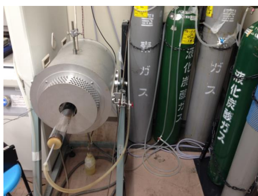
Fig. 3.2.3 電気炉 シリコニット TSH-530 (左), 窒素及び二酸化炭素ガス管 (右)
