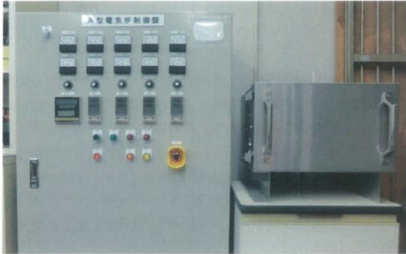
図 2.7 アニーリング処理装置 ( \text{Al}_2\text{O}_3:\text{Cr} セラミック TL スラブ)
