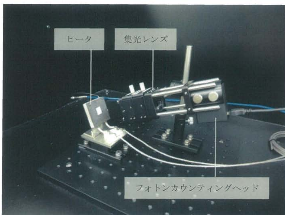
図 2.6 グロー曲線測定システム（暗箱内部）
