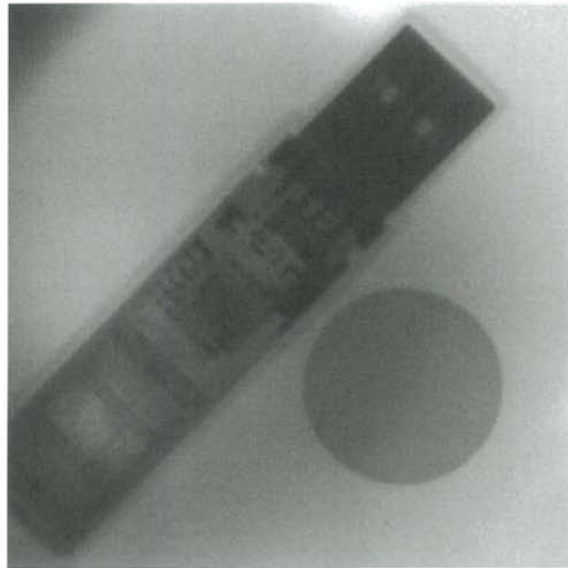
図 1.6 Al 2 O 3 セラミック板による USB メモリと一円玉硬貨の X 線像 2)
