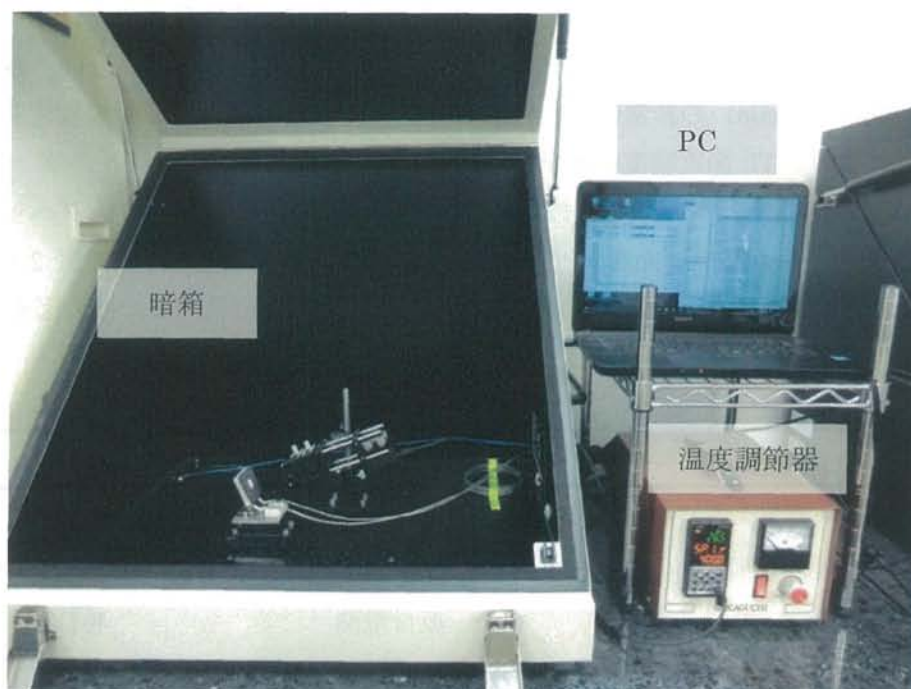
図 2.5 グロー曲線測定システム（全体図）
