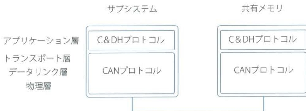
図 4.6 衛星内ネットワークと OSI 基本参照モデルとの比較図
