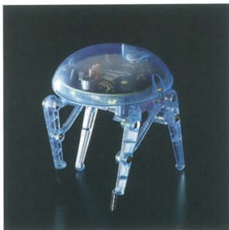
図3 音に反応して歩行するロボット 引用元 https://www.elekit.co.jp/product/MR-9602
