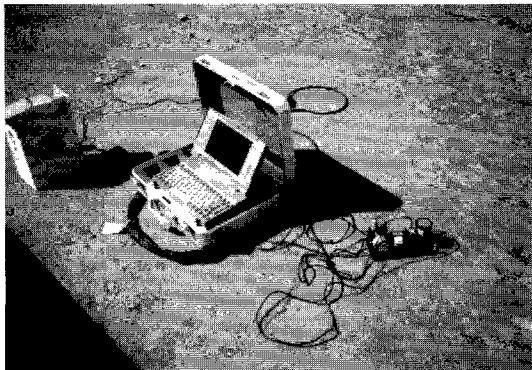
図72 常時微動観測の観測装置
