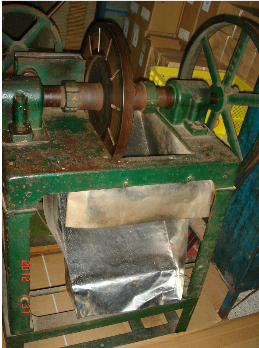
写真 3-2 削りかまぼこの削り機械（Z 社製，かまぼこ専用機）
