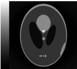
図8. 手順③の重み付けしながら 逆投影した再構成画像
