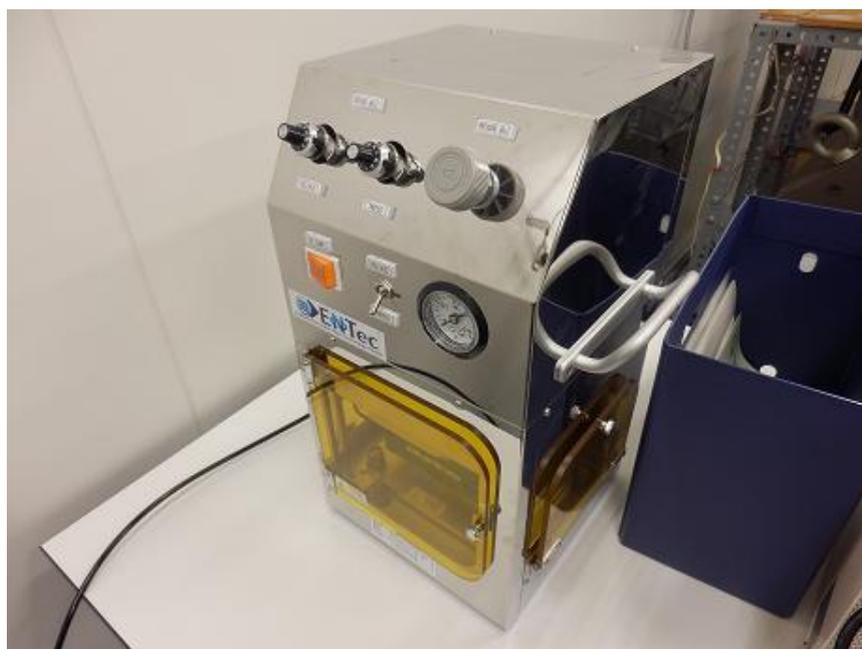
図 4-32 ナノインプリント装置の外観
