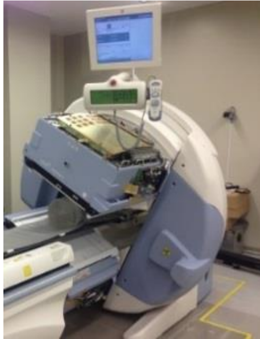
Fig.7.2 自作ファントムの SPECT 撮像の様子
