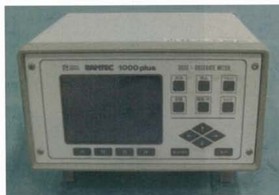
電位計 (RAMTEC 1000 plus, 東洋メディック社製)
