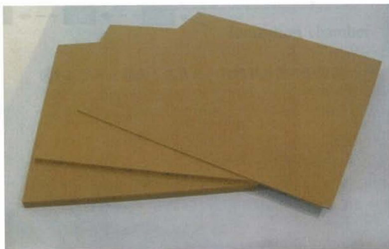
図5-1 固体水等価ファントム(Solid Water, Gammex社製)の外観
