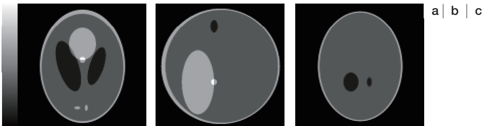
図6. 3次元数値ファントム 楕円体を組み合わせて作成したもの。 (a) 座標(64, 64, 80)を通る xy 断面(トランスバース) (b) 座標(64, 64, 80)を通る yz 断面(サジタル) (c) 座標(64, 64, 80)を通る xz 断面(コロナル)
