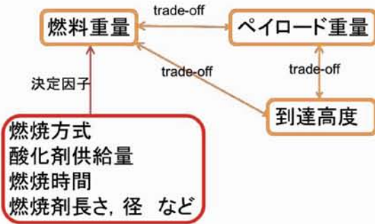
Fig.2 打ち上げ機設計の設計を決定する要因と性能のトレードオフ。
