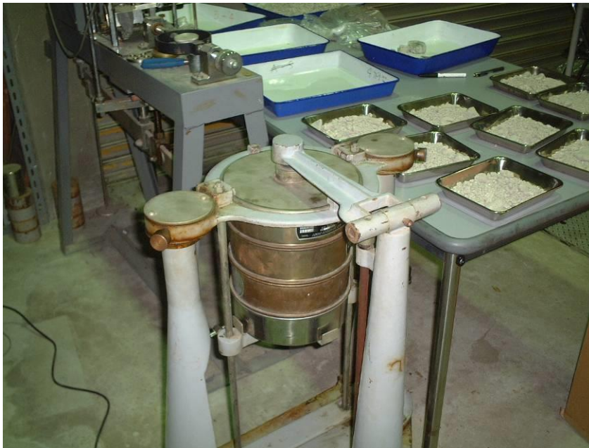
写真 4.9 2[mm]ふるい通過分 75[ \mu m]ふるい残留分に対するふるい分け
