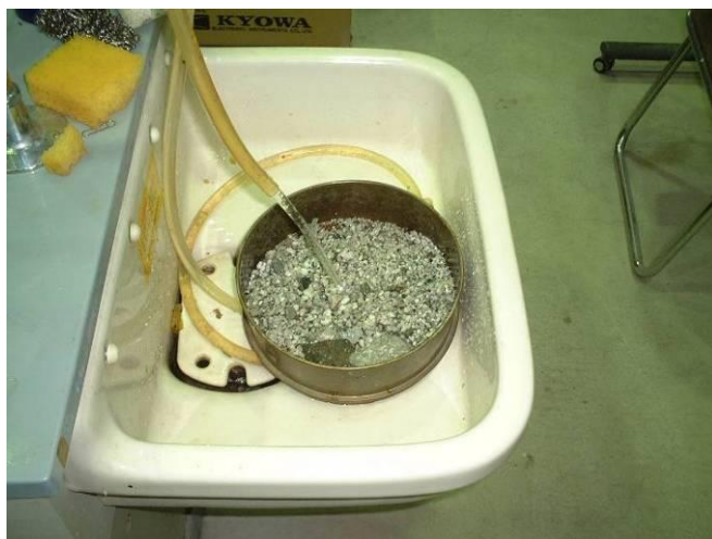
写真 4.6 2mmふるい残留分の水洗い
