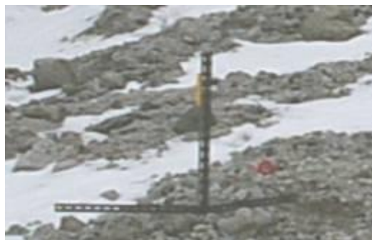
写真 2.47 アングル材を使用した基準点③ パスポイントの設置
