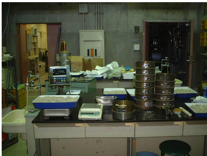
写真 4.8 2mm ふるい残留分ふるい分け試験概要写真
