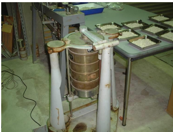
写真 4.7 2mm ふるい分け残留分のふるい分け
