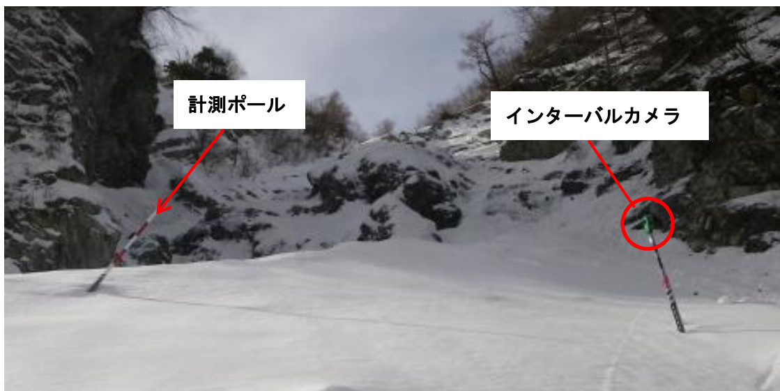
写真 2.8 積雪計設置後
