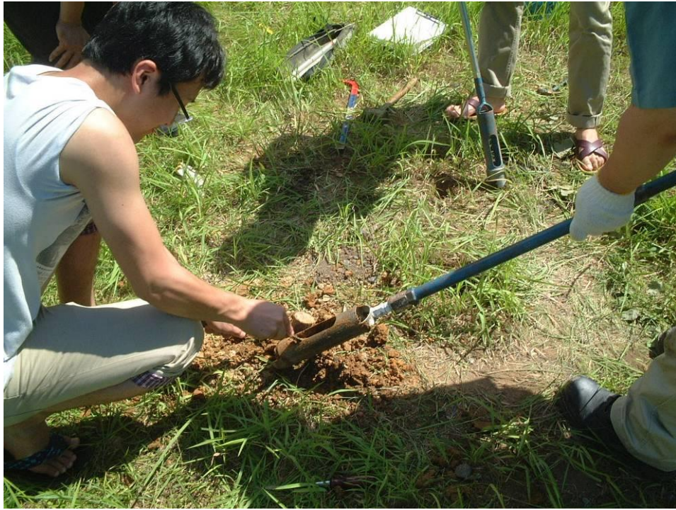
写真 3.3 ハンドオーガによる掘削
