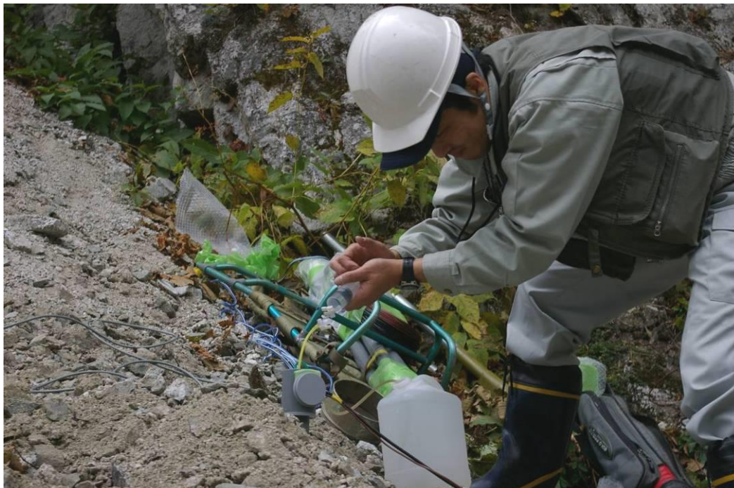
写真 2.18 脱気水の補給
