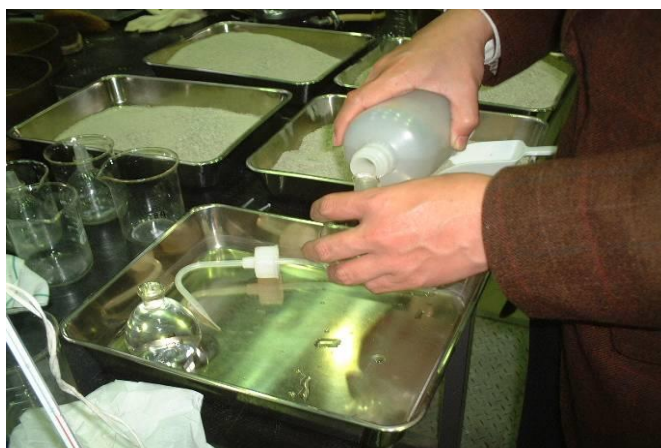
写真 4.2 ピクノメータに蒸留水を満たしている様子
