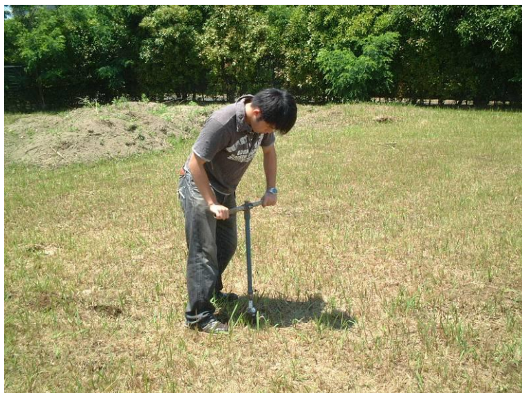
写真 3.13 ハンドオーガを用いた掘削
