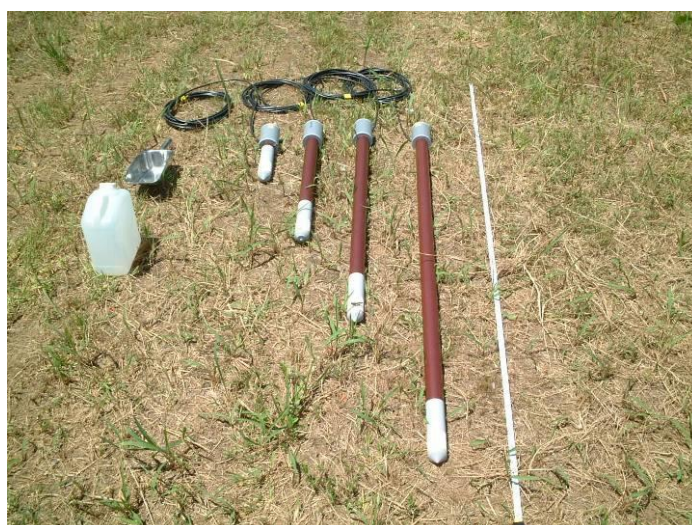
写真 3.2 設置したテンシオメータ (右から 120cm、80cm、50cm、20cm)
