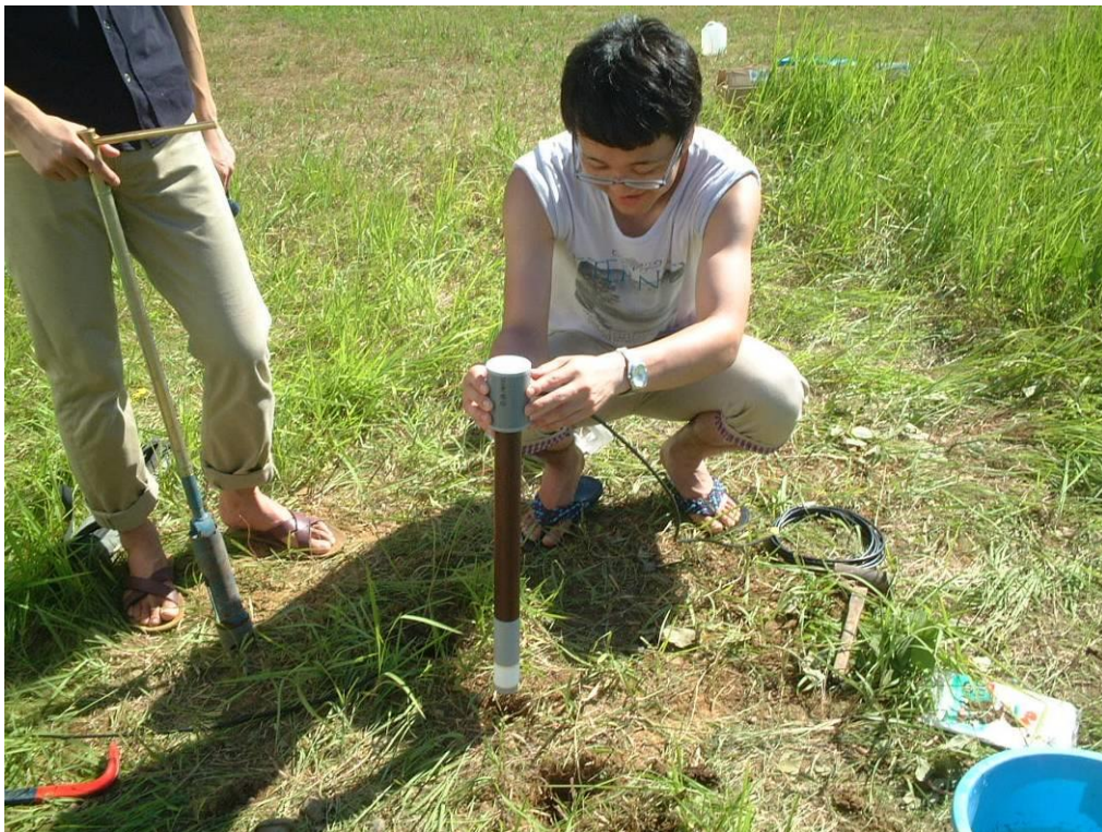
写真 3.4 テンシオメータの埋設
