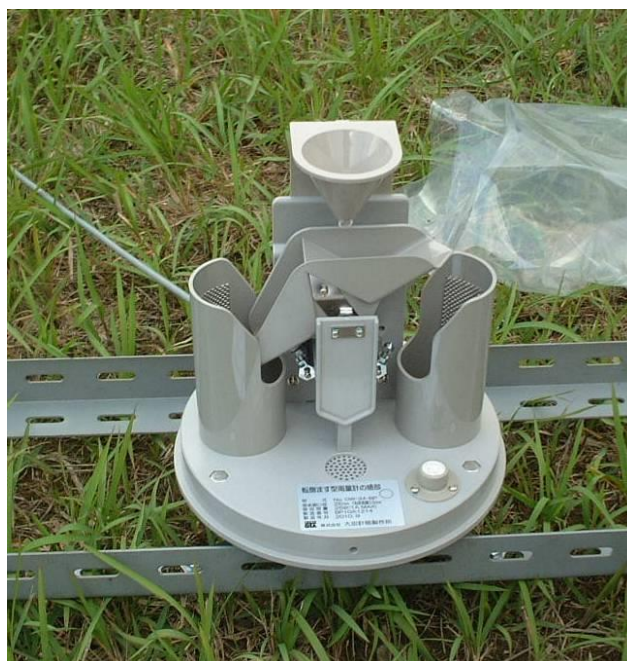
写真 3.8 使用した転倒まず型雨量計及びアングル
