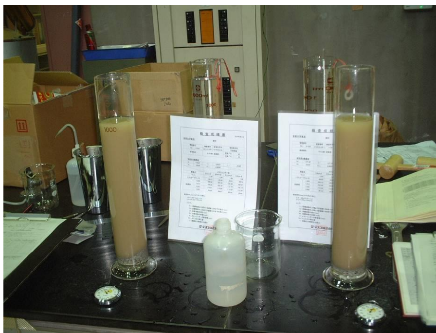
写真 4.12 沈降分析の様子
