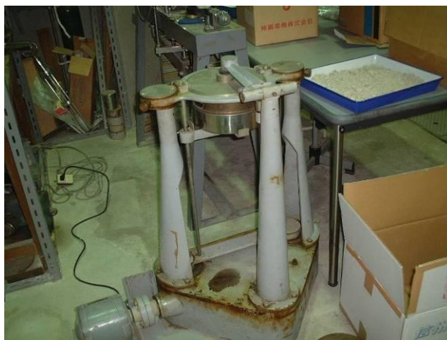
写真 4.5 2mmふるいによるふるい分けの様子
