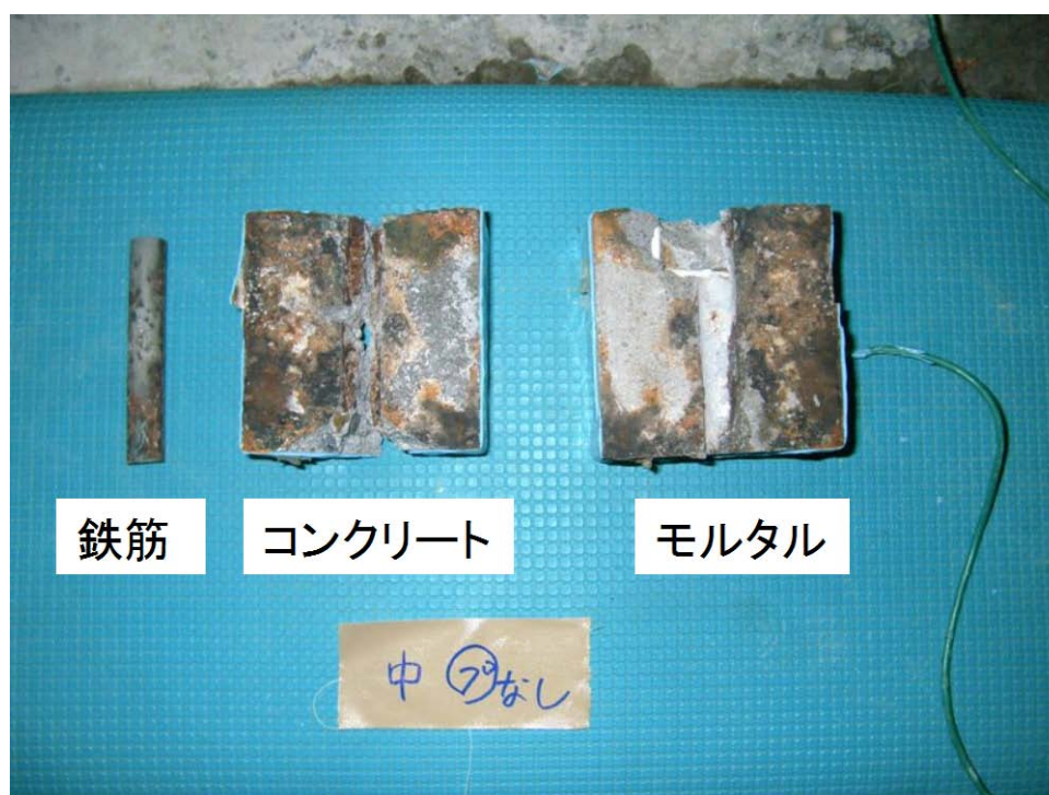
図 3. 3. 27 解体後の界面の状況（ケース 2）
