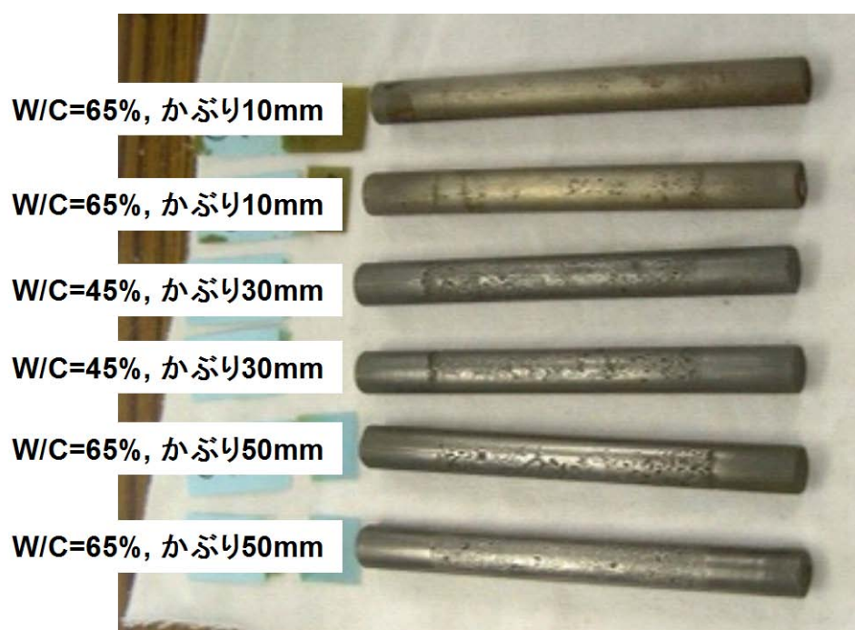
図 3.3.14 錆を除去した後の鉄筋腐食状況
