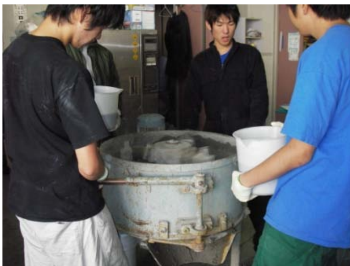
図 3.3.1 シリーズⅠで実施した練混ぜの状況（パン型ミキサー）
