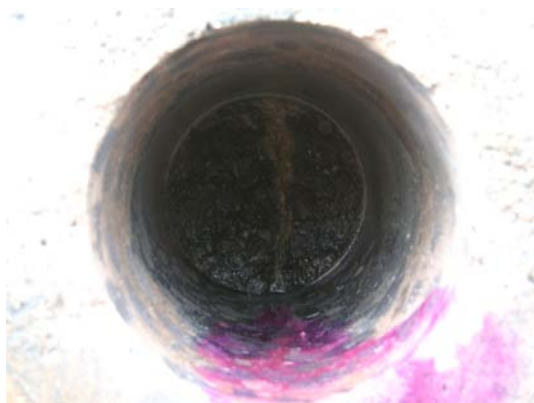
b) コア抜き位置の中性化深さ測定
