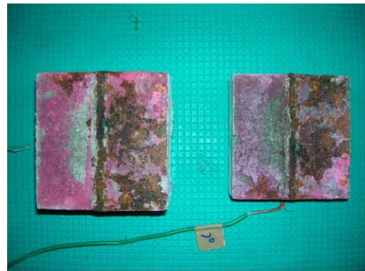
鉄筋上面まで補修 プライマーあり
