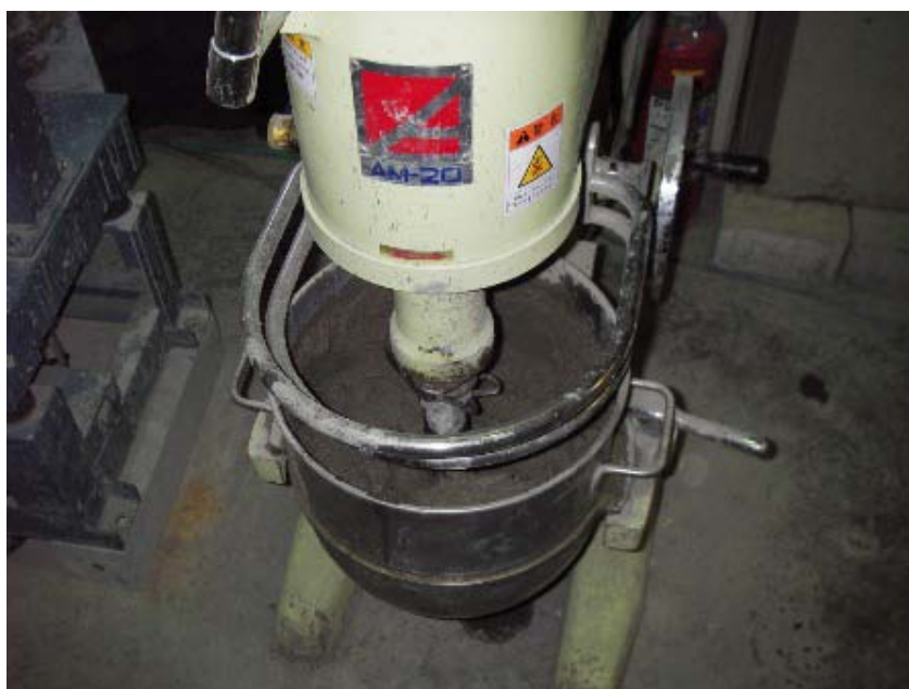
図 3.3.3 モルタルの練混ぜの状況
