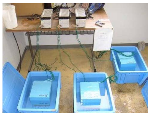
図 2.3.2 電気泳動法装置概要
