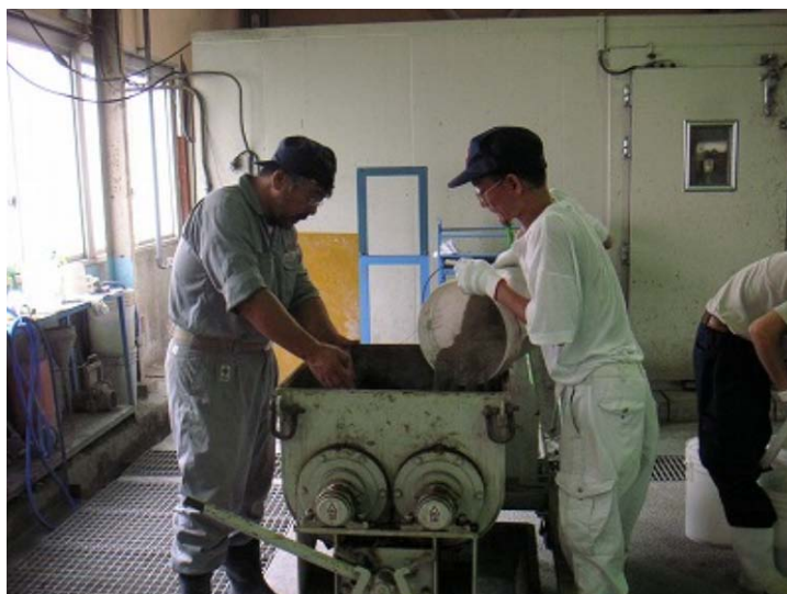
図 3.3.2 シリーズⅡで使用した練混ぜの状況（2 軸型ミキサー）
