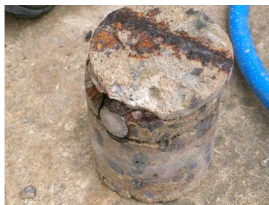
d) 鉄筋の腐食状況
