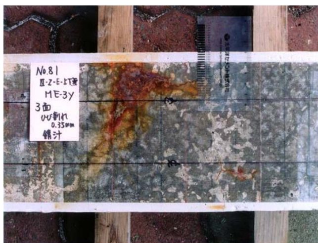
図 2.5.15 試験体表面に現れた錆汁
