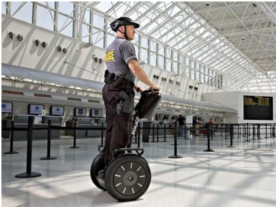
Fig. 1.2 倒立振り子型平行二輪車を用いた例<sup>(8)</sup>
