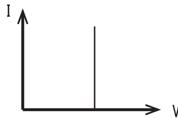
図 2-4 TBRTD に関する散乱・界面ラフネス・エネルギー準位広がりのない、 T = 0K 時のトンネル電流
