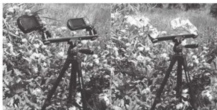
図 2. インターバル撮影の様子. 三脚に 1 台または 2 台のカメラを設置し (左写真), 日光によるカメラの加熱を防ぐためにアルミホイルで背面を覆った (右写真).
