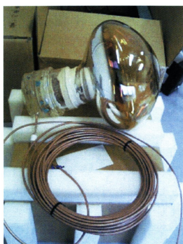
図 3.8: 実際の 10 インチ PMT の写真
