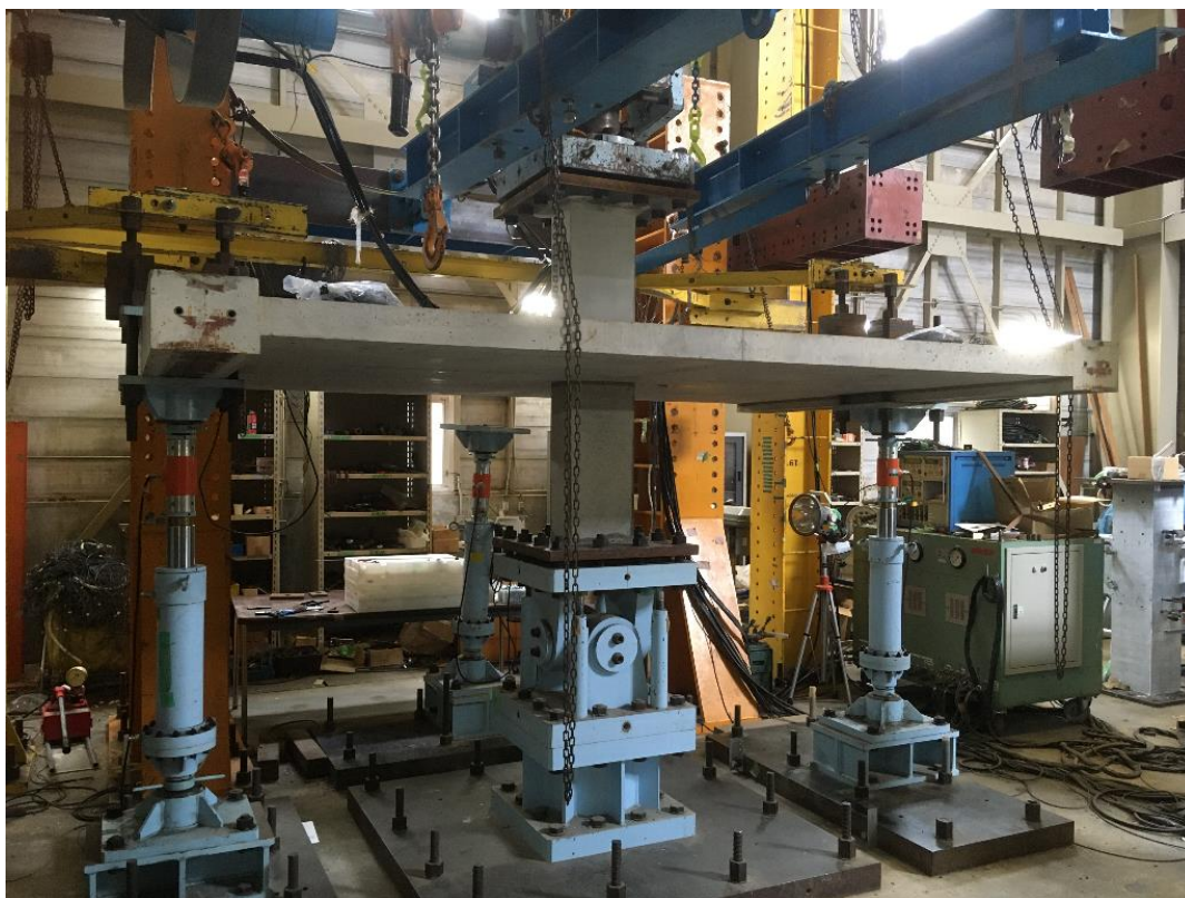
写真 3-2-1 加力装置セットアップ時
