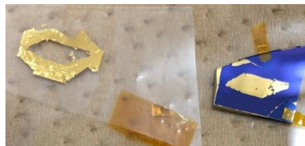
図 3-11 表面保護テープによる剥離 (転写後)
