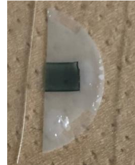
図 3-5 ゲルシートで保護した SWCNT 試料 (図は金属型)
