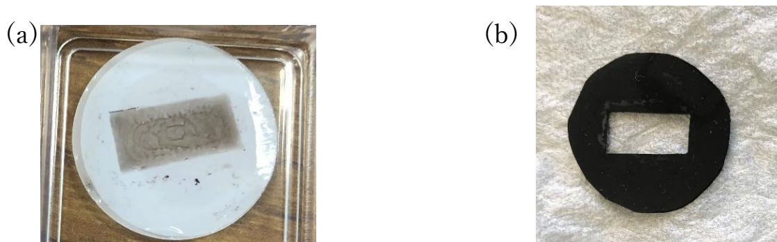
図 2-17 (a)フッ素樹脂を用いて作製した SWCNT 配向膜 (b)フッ素樹脂
