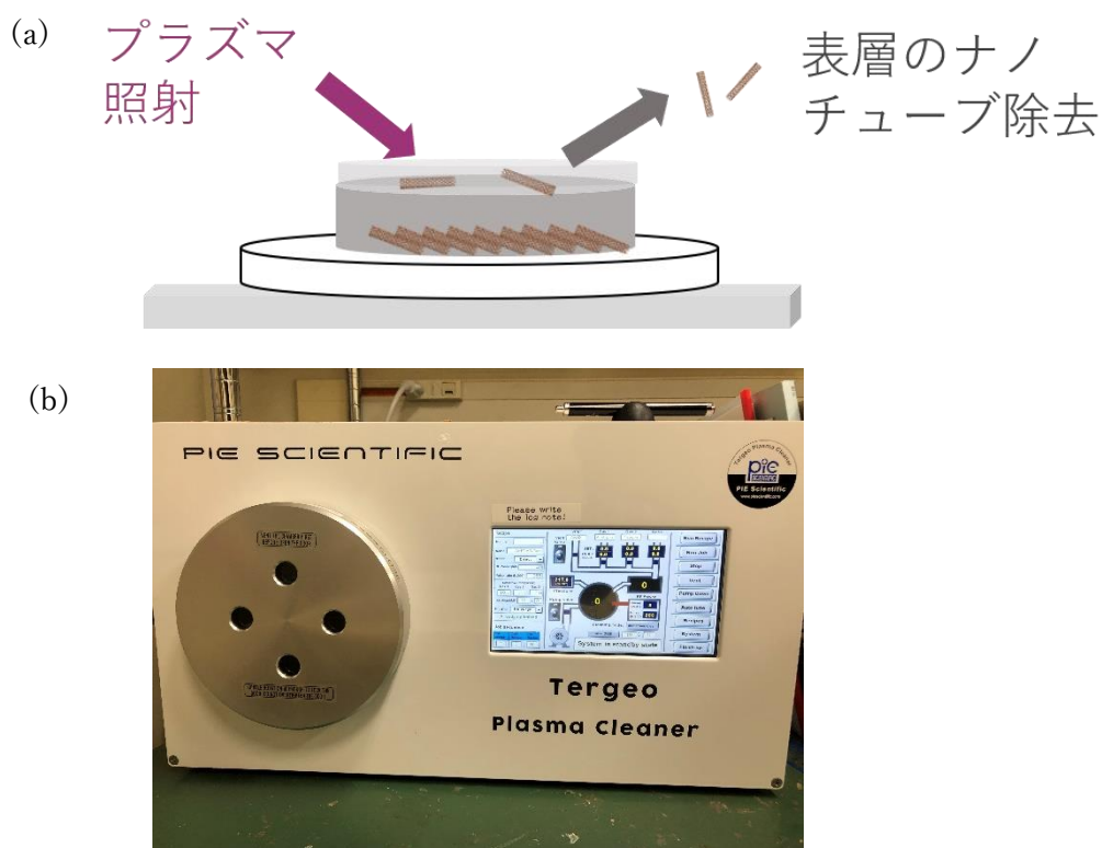
図 3-2 (a)プラズマ処理模式図 (b)プラズマクリーナー外観
