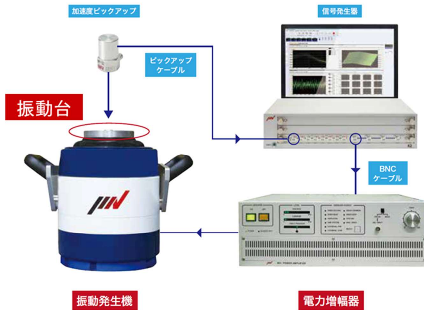
図 3-40 加振機のシステム構成 32)
