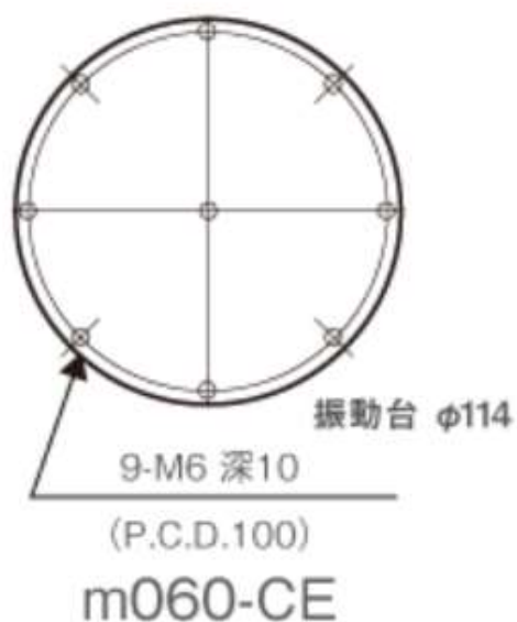
図 3-45 振動台（治具取付部）の寸法 34)
