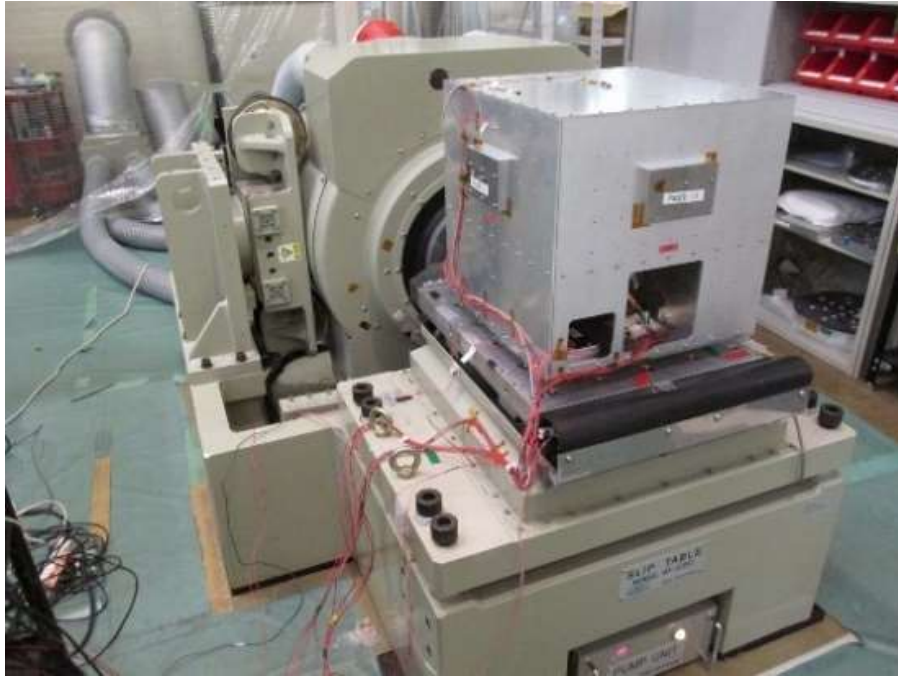
図 1-8 アルミハニカムパネル超小型衛星構体 10)
