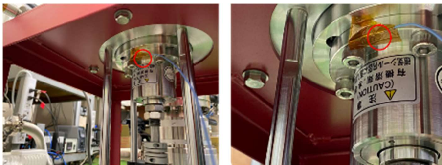
Fig. 2-6 磁性流体シール温度計測箇所（回転試験機）
