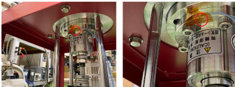
Fig. 2-12 磁性流体シール温度計測箇所（可視化試験）
