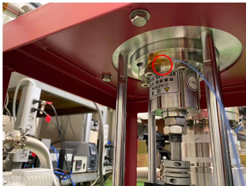
Fig. 4-3 磁性流体シール温度測定箇所
