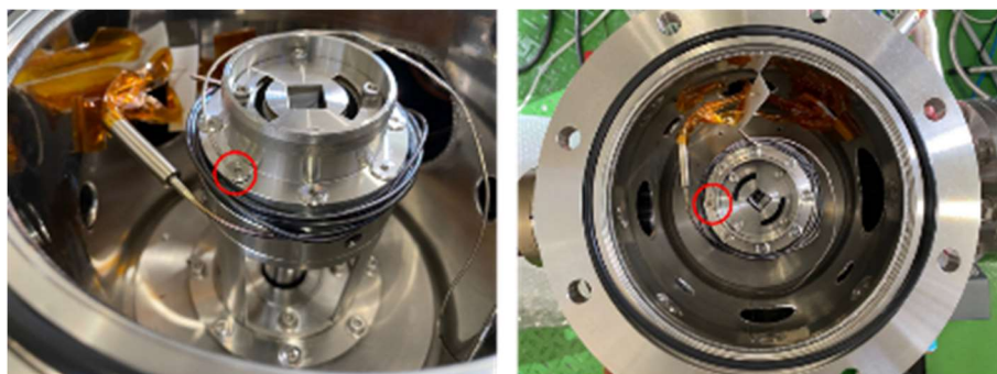
Fig. 2-13 オイルカップ温度計測箇所（可視化試験機）
