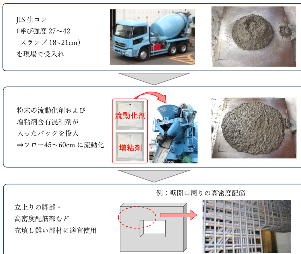
図4.1 後添加型の中流動・高流動コンクリートの概要
