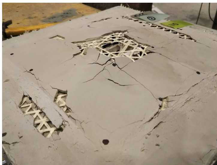
写真 5-3 C試験体・浮き3×3・目地Lの110cm落下後の表面
