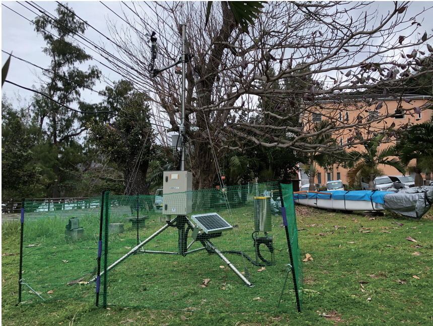
図9 父島の扇浦園地横に設置した自動気象観測装置
