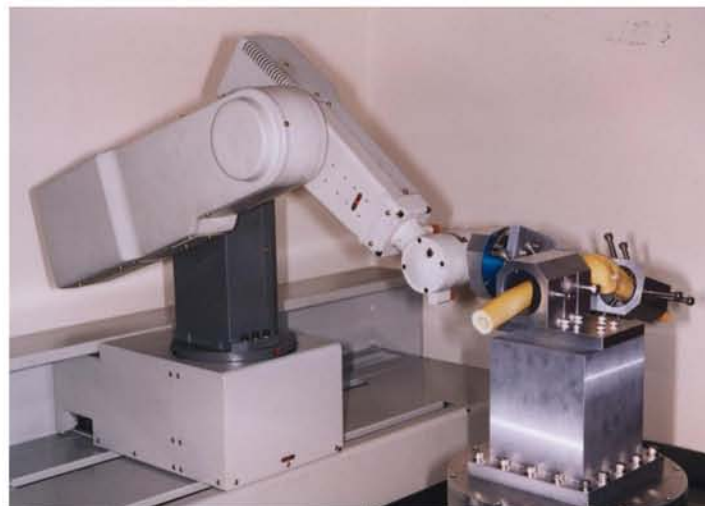
Fig.3 関節力学試験ロボットシステム 1 号機 [3]
