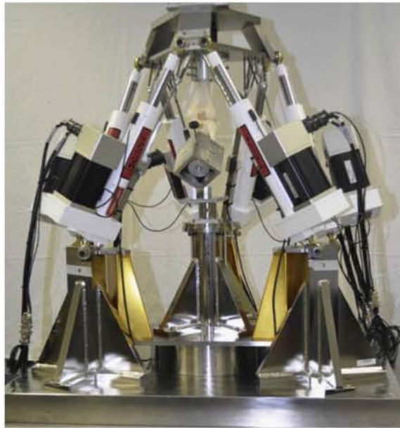
Fig.4 パラレルリンク機構を応用した関節力学試験ロボットシステム [13]
