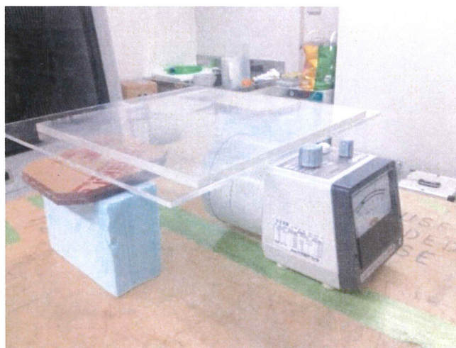
図 5.1 1.5 cm 厚の亚克力を設置した電離箱式サーベイメータ
