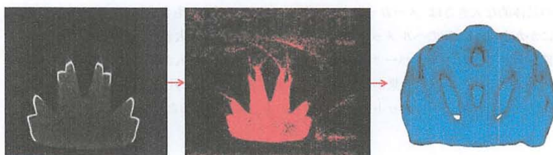
Fig.3.6.2 自転車用ヘルメットモデル構築手順
