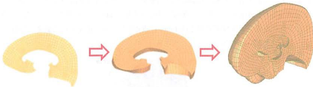
Fig. 3.2.5 大脳モデルの構築手順
