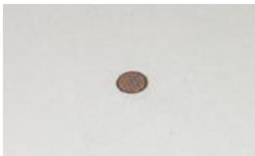
図 3-34 TEM 測定試料の例
