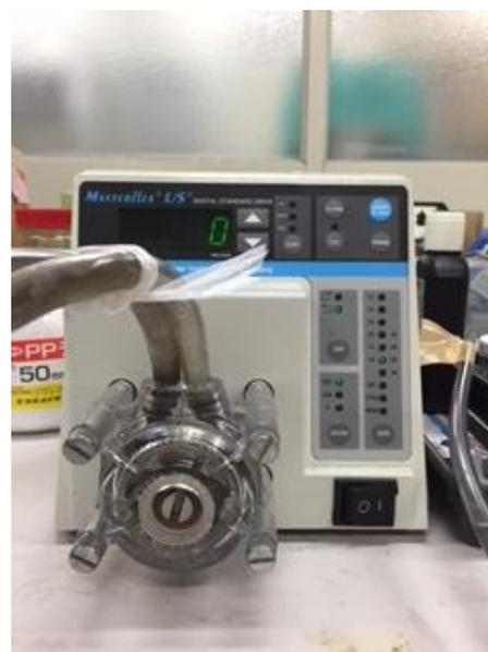
図 4-11 流速可変ポンプ
