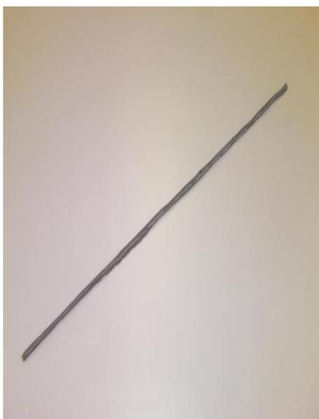
図 4-10 SUS430 の 100 μm 磁性線フィルタ
