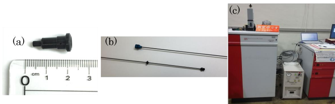
図 2-2 (a)アダプターストロー。(b)カーボンロッド。(c)SQUID 磁束計。(a)と(b)の画像は Quantum Design 社 MPMS パーツお見積もり依頼フォームより引用。
