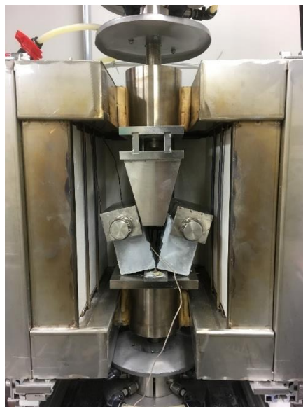
写真 4.7 くさび割裂試験風景
