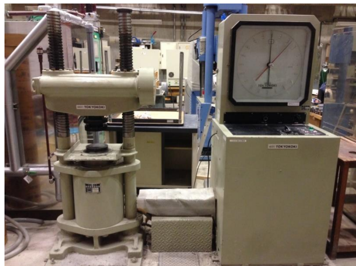
写真 3.8 1000kN 耐圧式試験機
