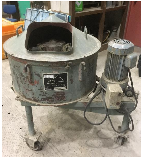
写真 4.1 パン型強制練リミキサ
