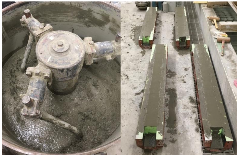
写真 4.2 供試体打ち込み風景
