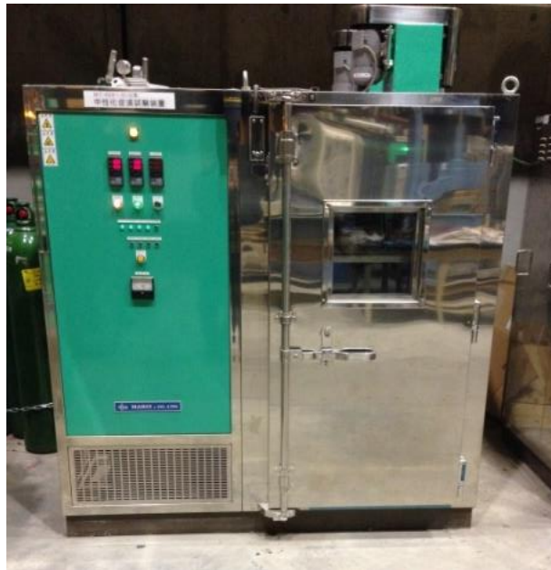
写真 3.5 中性化促進試験装置
