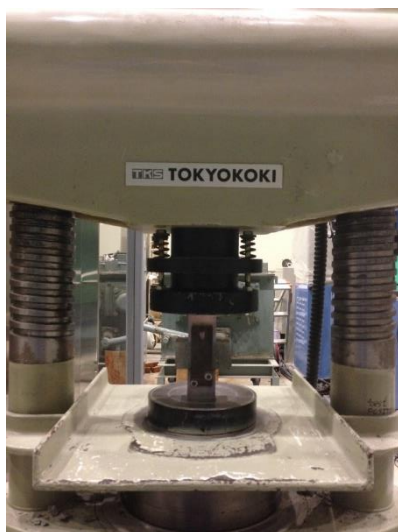
写真 3.7 圧縮強度試験風景
