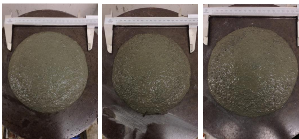
写真 3.1 フロー試験
