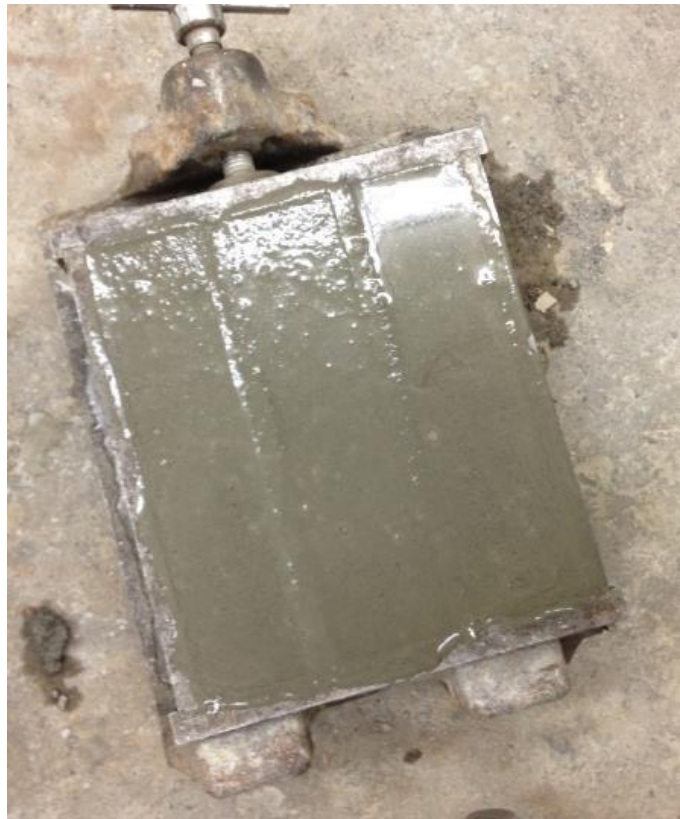
写真 3.3 供試体打込み時風景
