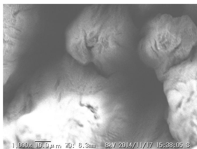
写真 4 洗浄後のグラファイト表面
