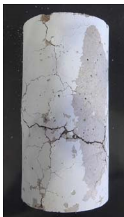
粗骨材に砂岩を用いた供試体(加熱温度 800℃)
