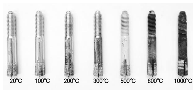
写真 7.6 加熱および引抜き試験後のアンダーカット式アンカー（埋込み長さ 40mm）
