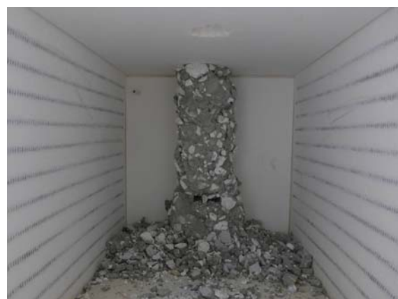
粗骨材に石灰岩を用いた供試体(加熱温度 700℃)
