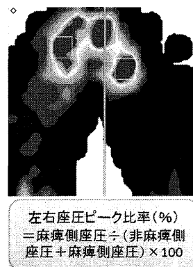
図 2 座圧測定から得られたサンプル例
