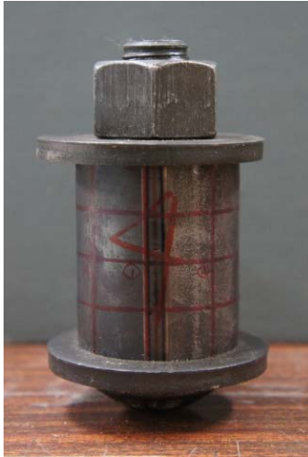
図 3-10 締付け後の鋼管の変形
