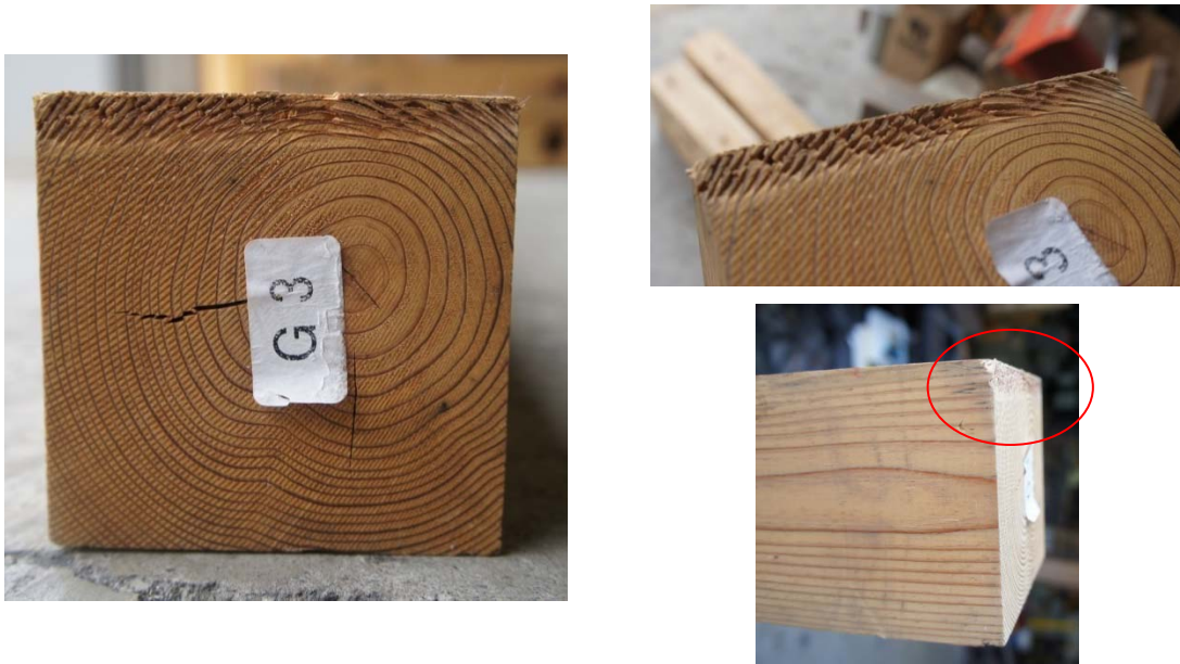
図 2-8 試験体解体後の木材接触部の損傷状況
