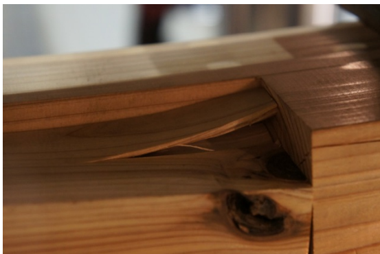
(b) 接触部の損傷
