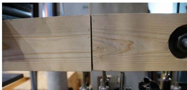
図②-4 試験体接触部の隙間
