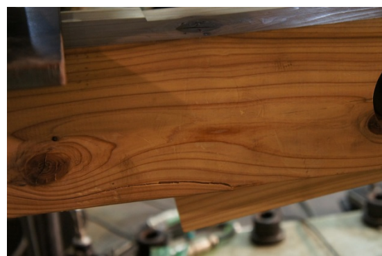
(c) 木材下端の損傷
