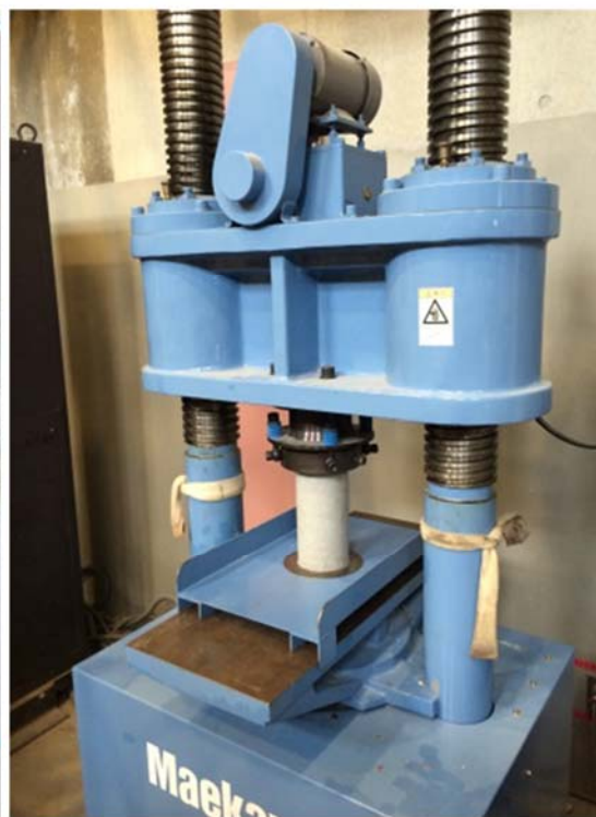
写真－3.12 圧縮強度試験機
