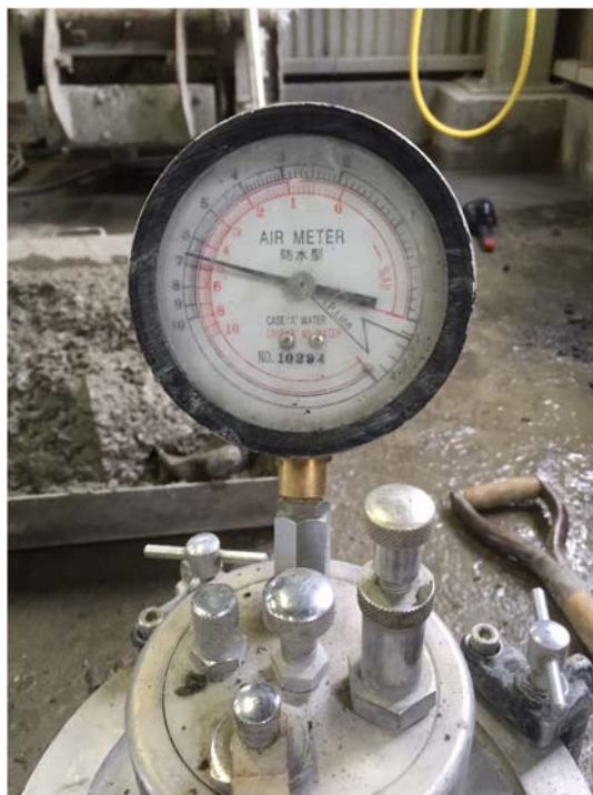
写真－3.6 空気量試験
