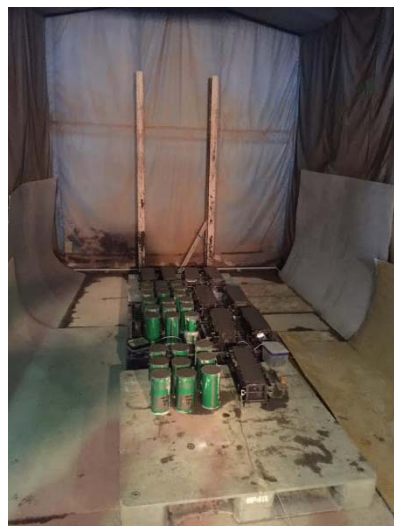
写真－3.4 蒸気養生槽内部 と供試体設置状況
