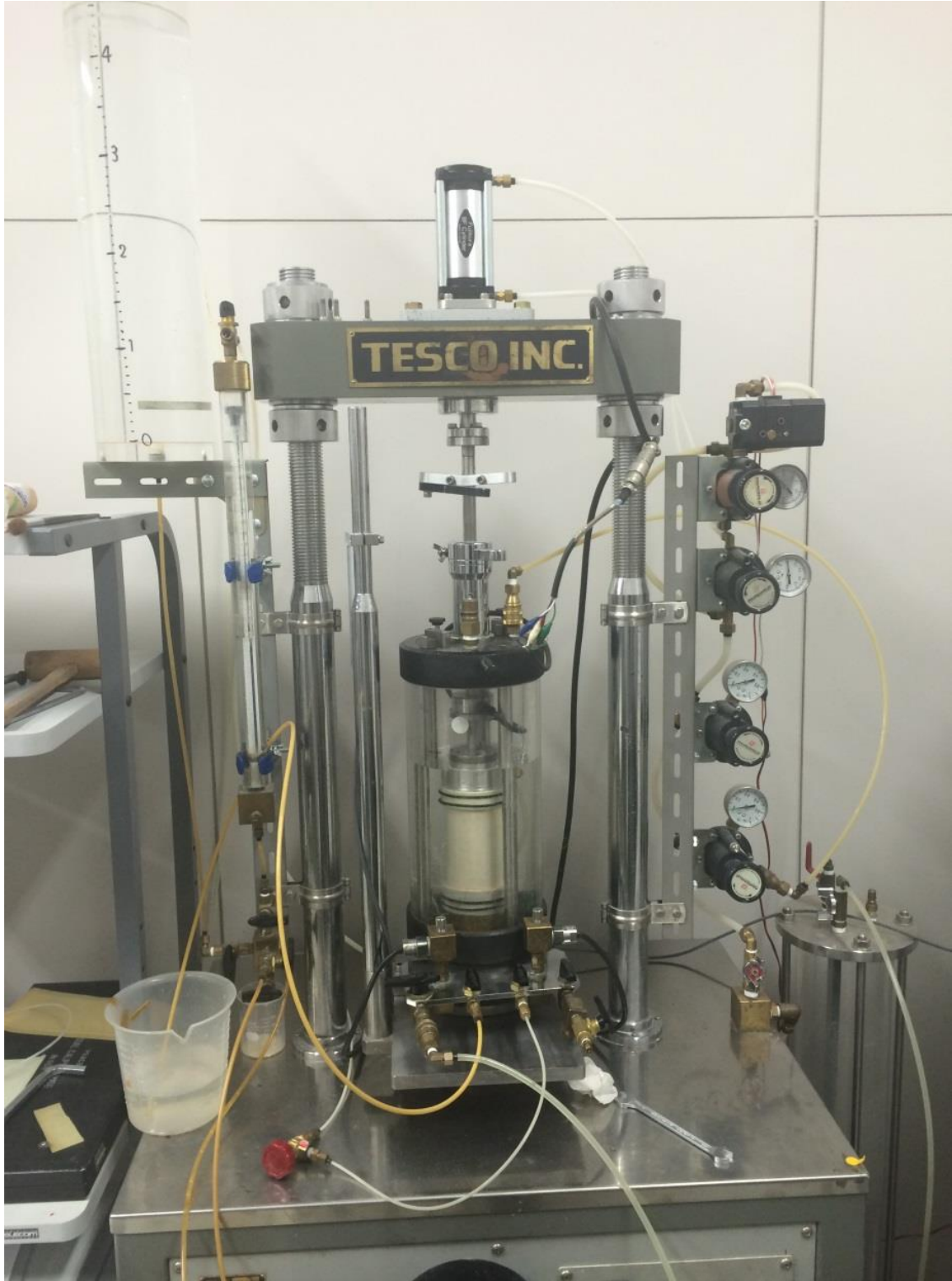
写真3-6 三軸圧縮試験試験装置の全体
