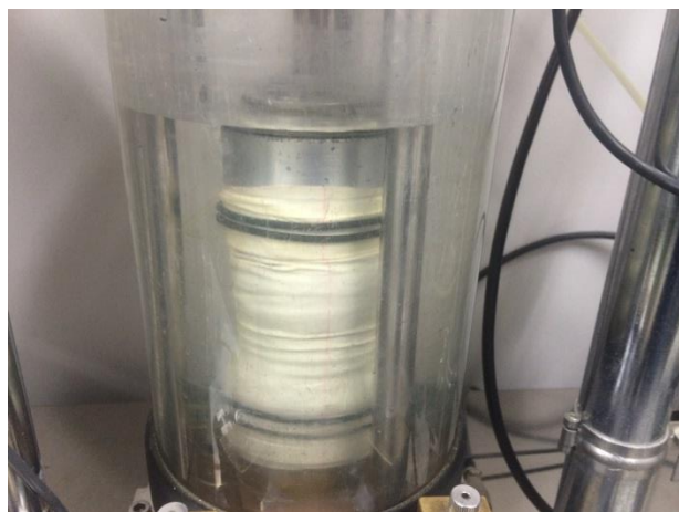
写真3-27 間隙水圧がセル圧より大きくなったため供試体が破壊した
