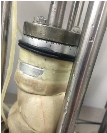
写真3-26 せん断が終わるときメンブレンに大きい穴が生じた
