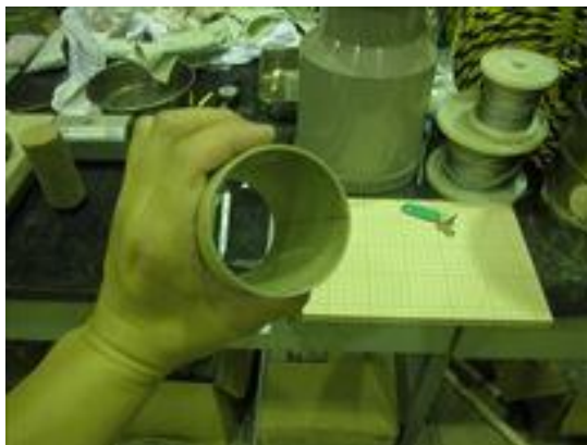
写真3-13 メンブレンを型枠に被せる
