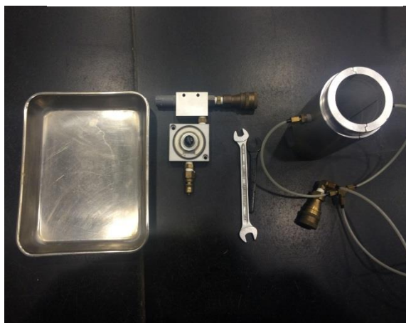
写真3-10（左から順に） 金属バット、負圧発生装置、 スパナ、モールド
