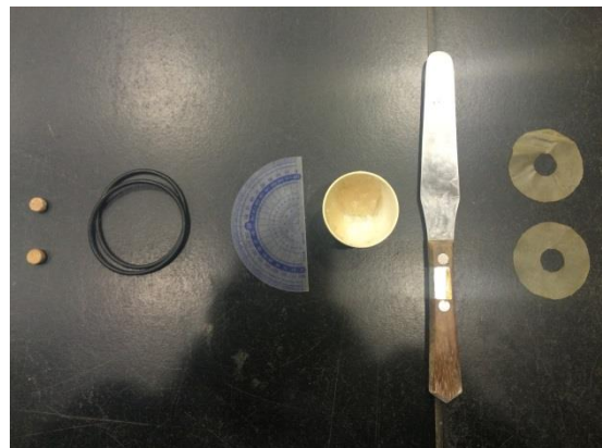
写真3-8（左から順に） ポーラスストーン、オーリング、 分度器、グリス、金属へら、 端面摩擦除去用メンブレン
