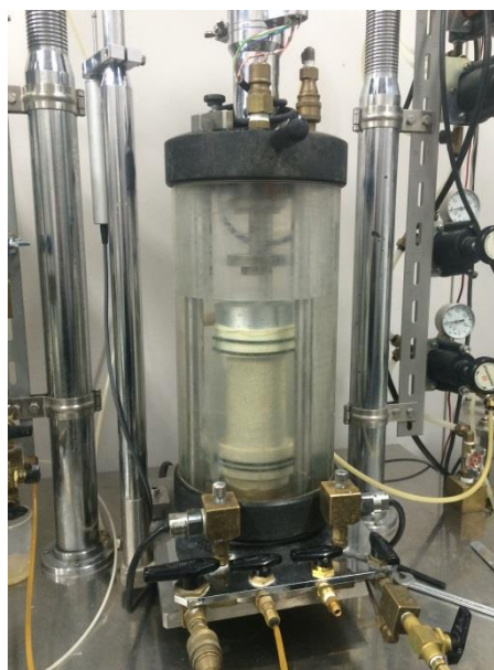
写真3-16 セル水の注入
