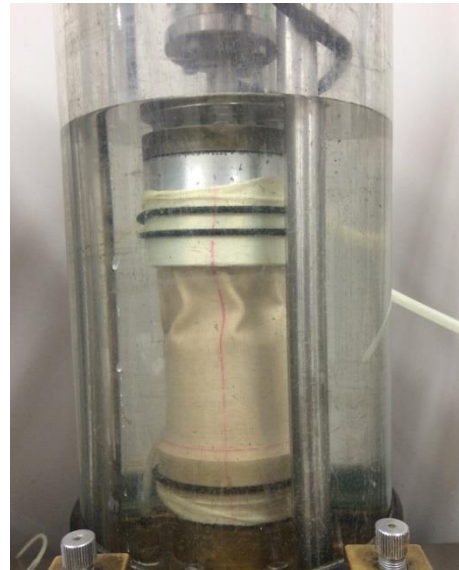
写真3-25 水平圧力を調整するときロードセルの軸が固定された
