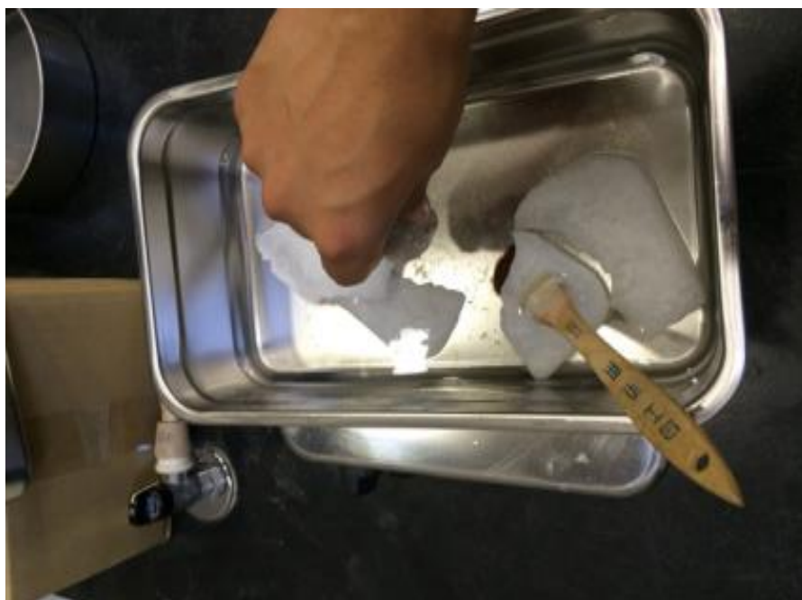
写真2-7 供試体を溶融したパラフィン液中に浸す
