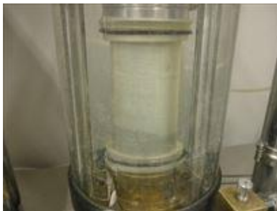
写真3-17 脱気水の供給
