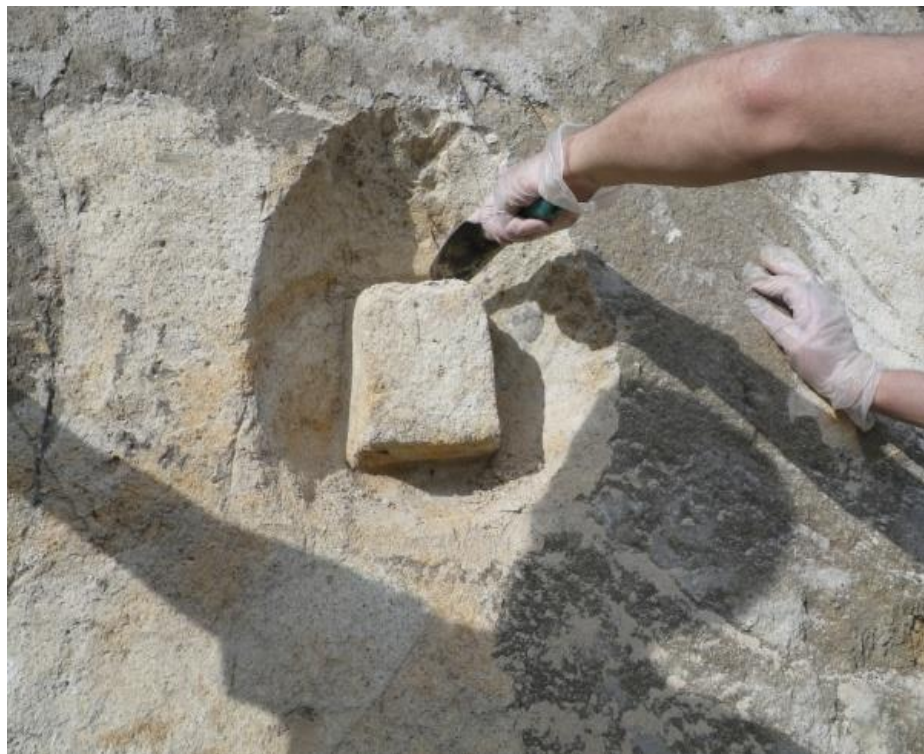
写真2-3 左岸で採集したブロックサンプリング
