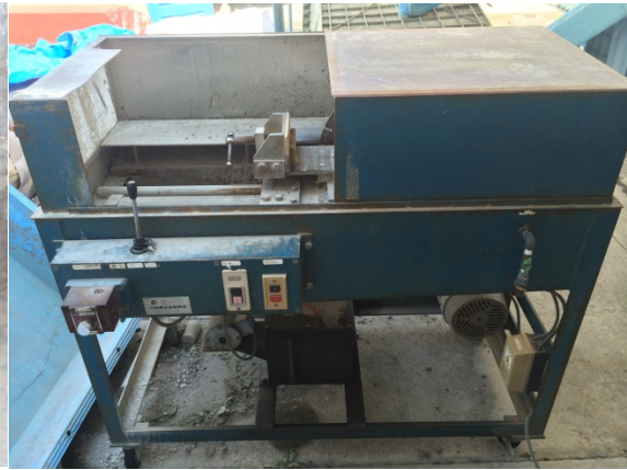
写真-3.9 湿式コンクリートカッター
