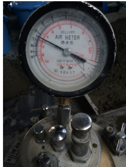
写真-3.5 空気量試験
